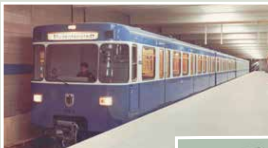
Münchner U-Bahn, WMD Donauwörth, 1965 – 1971, Aluminium-Leichtbauweise; Foto: © Airbus Helicopters
